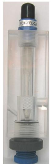
Die Chlorelektrode (5) besteht aus einer großflächigen Goldronde, die in den PVC-Körper (Elektrodenhalter) eingesetzt ist. Dieses Elektroden-System wird von unten in die Messzelle eingeschraubt. Glaskügelchen, die durch das einströmende Messwasser auf der Elektrodenoberfläche bewegt werden, halten diese sauber. Das Bezugssystem (15) besteht aus einer Ag/AgCl -Elektrode und wird von oben in die Messzelle eingeschraubt.
